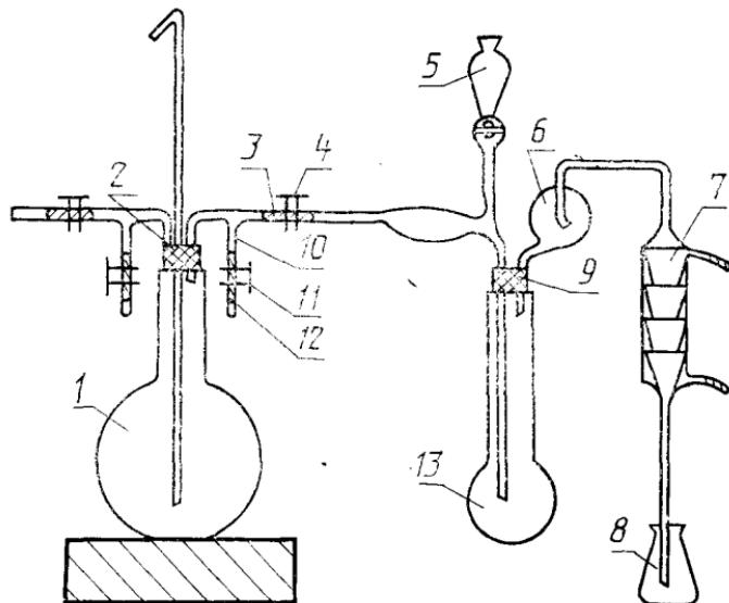
1 — парообразователь — плоскодонная колба вместимостью 500—750 см<sup>3</sup>; 2, 9 — резиновые пробки; 3, 12 — резиновые трубки; 4, 11 — зажимы; 5 — наполнительная воронка для приливания воды; 6 — каплеуловитель; 7 — холодильник; 8 — приемник — коническая колба вместимостью 100—250 см<sup>3</sup> с меткой 80—90 см<sup>3</sup>; 10 — отводная трубка; 13 — реакционная колба (типа Кельдаля) вместимостью 250—500 см<sup>3</sup>.
